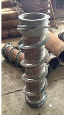
Figura 2. Tubos metálicos para execução da estaca Hollow Auger .
