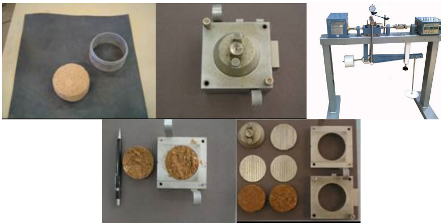
Figura 2.7 Equipamentos e sequência de montagem do Ensaio de Cisalhamento Direto
